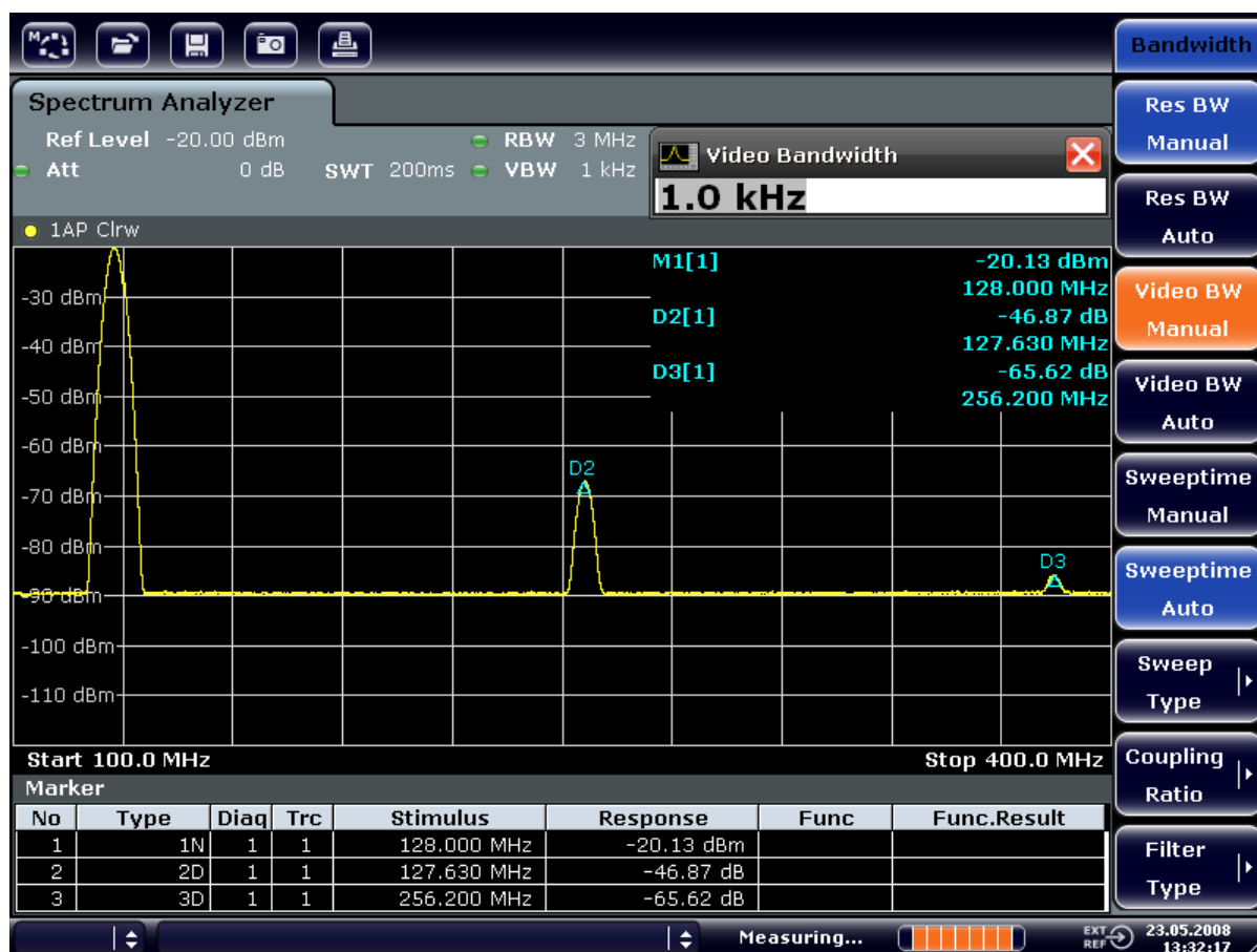
Fig. 6-11 : Suppression du bruit par diminution de la largeur de bande vidéo en mesure des harmoniques
